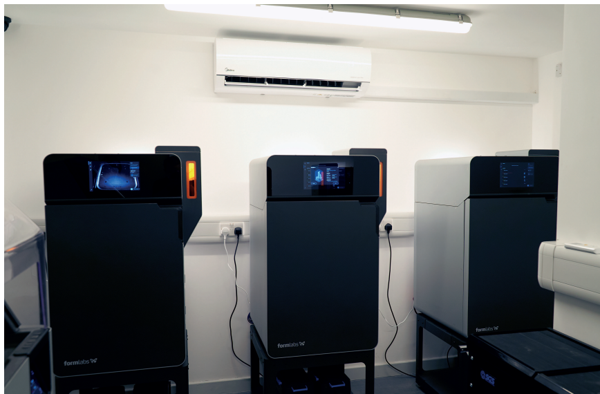
Die Fuse-1-Drucker von Formlabs kommen bei Vital Auto hauptsächlich für robuste Bauteile zum Einsatz. © Vital Auto
